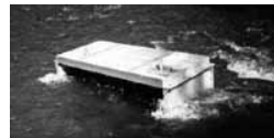
Простейшая турбина для извлечения вращательной компоненты потока. Это просто ящик, где на двух шестеренчатых блоках двигаются цепные передачи, на которых насажены лопасти определенного наклона. (Снимок предоставлен Мартяновым А.В.)
